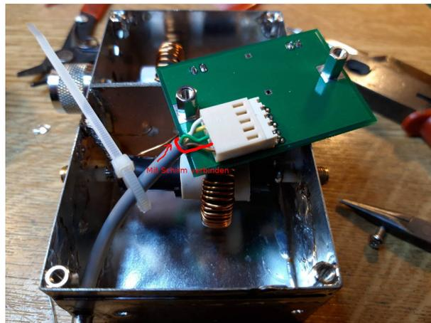
Messplatine mit angestecktem Verbindungskabel zum Wattmeter. **Die neusten Erkenntnisse sind: Der Schirm wird auf dieser Seite des Kabels auch mit angeschlossen.** Ich habe 2 Litzen 0,14mm mit dem Schirm verdreht und an den Stecker angeschlossen. Ich habe das im Bild rot eingezeichnet.
