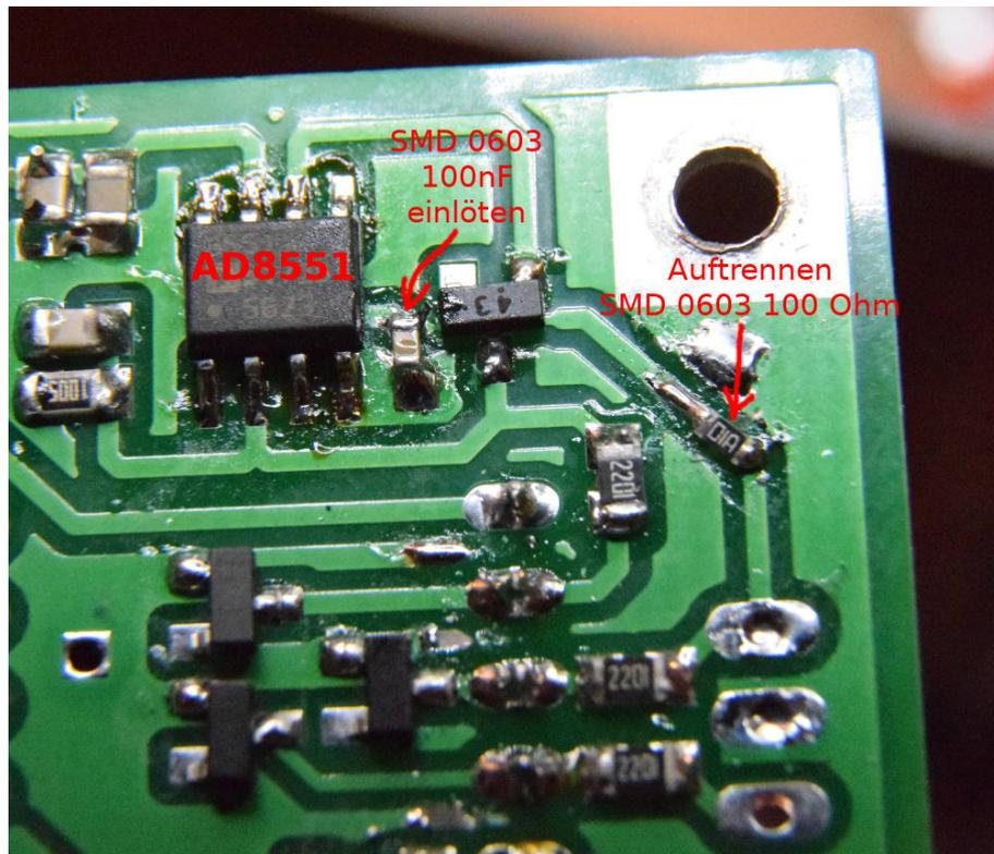
Hier ein Foto von meiner Leiterplatte. Der Leiterzug wird aufgetrennt und 100 Ohm eingefügt. Den 100nF 0603 löten wir ganz nahe am AD8551 an. Am Leiterzug entfernen wir vorher den Schutzlack. Die GND Seite des Kondensators löten wir direkt auf die Durchkontaktierung.
