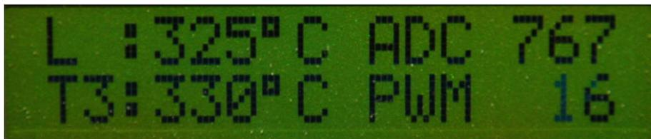
Ansicht des Displays. L=Lötkolbentemperatur, T3=gespeicherte Temperatur Taste 3, ADC=A/D Wandler 10Bit Wert Wertebereich 0..1023), PWM= Pulsweite Wertebereich 0..1023.
