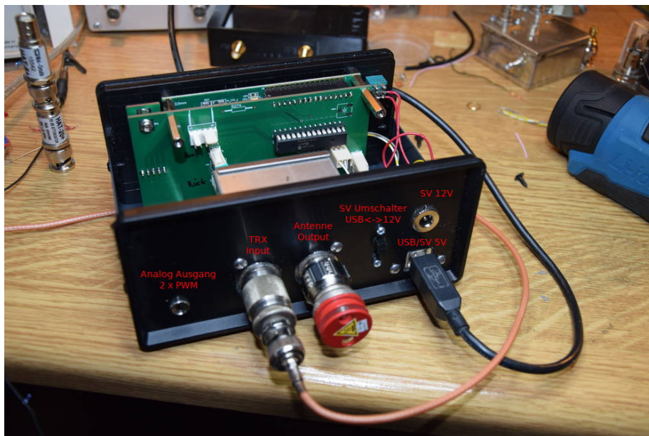
An der Rückwand befinden sich alle Anschlüsse. Ich habe die Anschlüsse im Bild beschriftet. Als Antenne habe ich eine kleine Dummyload angeschraubt. Die Stromversorgung ist hier in diesem Fall direkt vom USB-Kabel des PC. Der SV-Auswahlschalter ist nach unten geschaltet (USB-SV).
