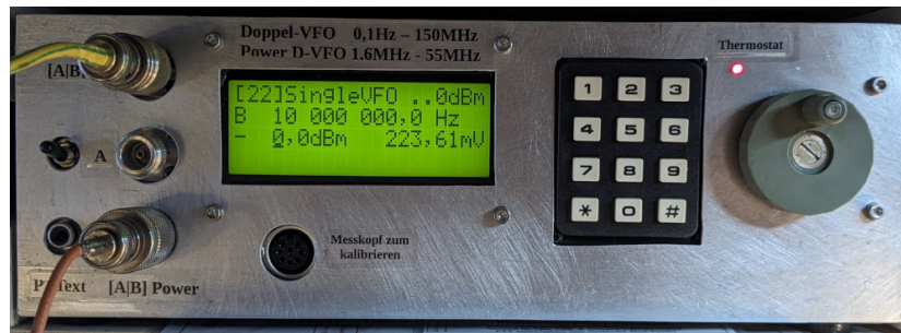
Doppel-VFO -140dBm bis etwa +3dBm in 0,1dB Schritten, IM3 -90dBc. Frequenz 0,1Hz bis 150MHz. Leistungsausgang Doppel-Pegel bis 15 Watt PEP IM3 -60dBc. Frequenz 1,6 MHz bis 55 MHz.
