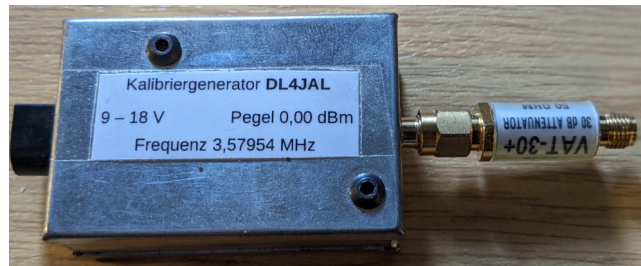
Mein 0,0dBm Generator mit aufgeschraubten Dämpfungsglied 30dB von Mini-Circuits .
