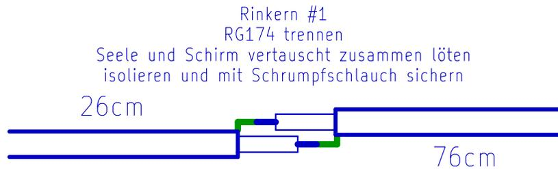
Durch diesen Trick kann die Hilfswicklung, 8 Windungen Kupferlitze, links am Anfang mit dem Schirm des RG174 und rechts am Ende auch mit dem Schirm des RG174 verlötet werden.
