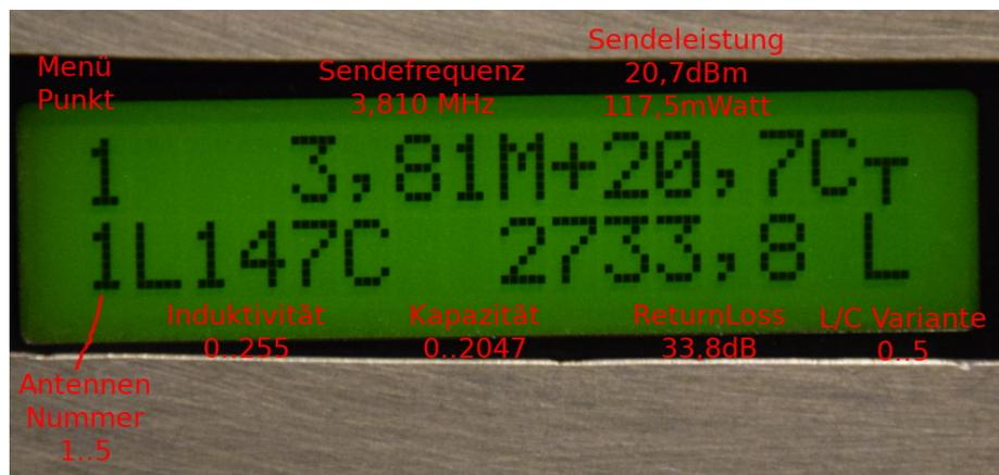
In diesem Fall sehen wir eine Anpassung an meine Kunstantenne. Die Leistung ist etwas über 100mW. Das ReturnLoss ist sehr gut. Umgerechnet entspricht RL 33,8dB einem SWR von 1,04.
