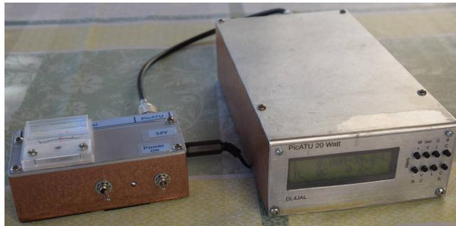
Hier die kleine PicATU Ausführung mit maximal 20 Watt Belastung. Für die Fernbedienung verwende ich die gleiche Baugruppe wie beim *PicATU 20W*.
