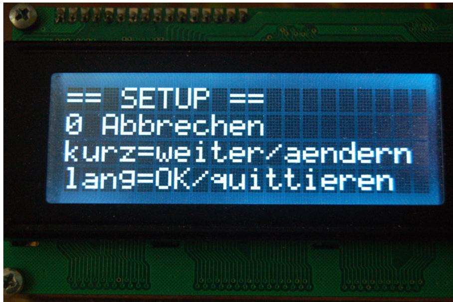
Abbildung 3.10: So sieht der Einstieg in das SETUP aus. Als erster Punkt wird der Abbruch eingeblendet.
