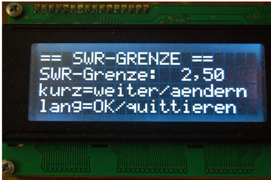
Abbildung 3.11: Hier wurde der Parameter „SWR-GRENZE“ ausgewählt. Wir sehen den eingestellten Wert. Mit einem kurzen Tastendruck wird der Wert geändert. Ein langer Tastendruck speichert die Einstellung im Eeprom
