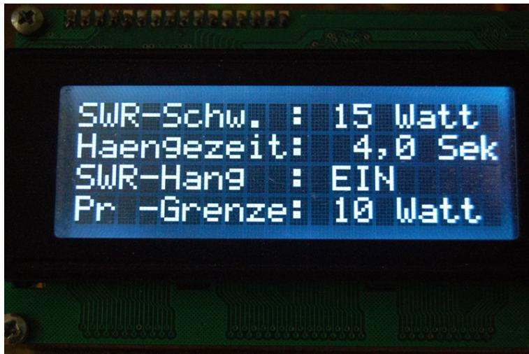
Abbildung 3.3: Ansicht der Softwareparameter Seite 1 im LCD-Display beim Hochlauf.
