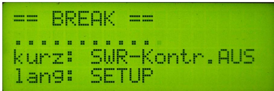
Abbildung 3.7: Ansicht der LCD-Anzeige: Während des Drückens des RESET-Tasters ohne aktivierte Leistungseinstellung der LED-Zeile
