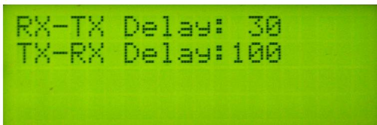
Abbildung 3.4: Ansicht der Softwareparameter Seite 2 im LCD-Display beim Hochlauf.
