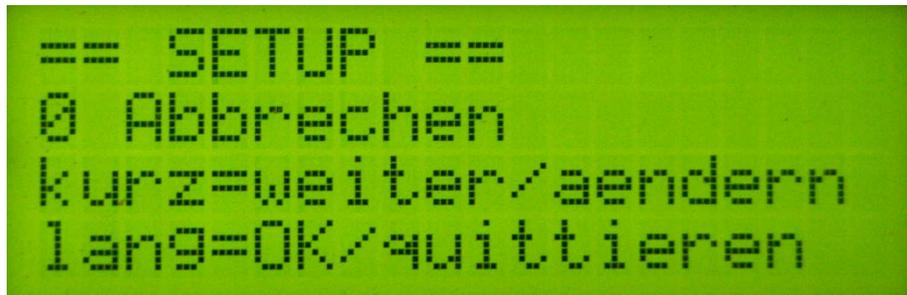
Abbildung 3.10: So sieht der Einsprung in das SETUP aus. Als erster Punkt wird der Abbruch eingeblendet.
