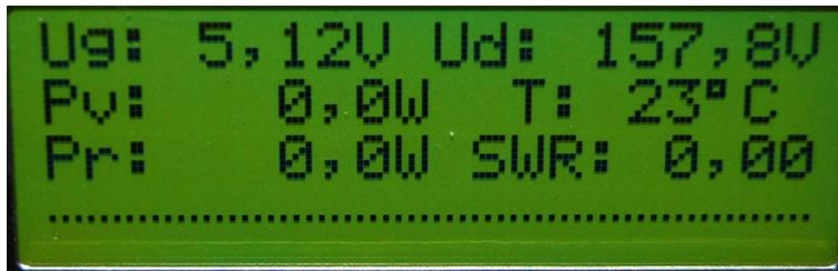
Abbildung 3.5: Ansicht der LCD-Anzeige: PA im Ruhebetrieb.
