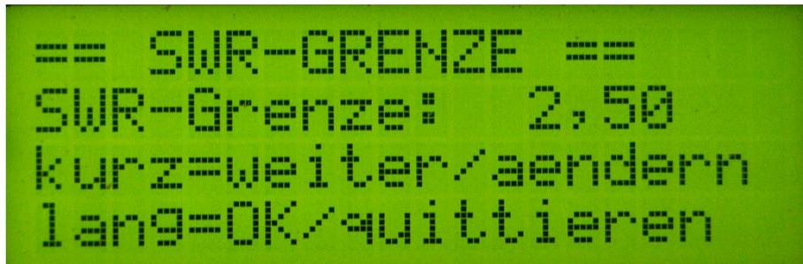
Abbildung 3.11: Hier wurde der Parameter „SWR-GRENZE“ ausgewählt. Wir sehen den eingestellten Wert. Mit einem kurzen Tastendruck wird der Wert geändert. Ein langer Tastendruck speichert die Einstellung im Eeprom
