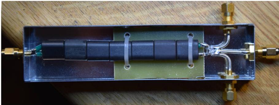
Bevor die beiden RG45-Kabel mit der Messbrücke verlötet werden, muss mechanische Stabilität hergestellt werden. Es wird ein Stück Leiterplattenmaterial an das Weißblech auf beiden Seiten angelötet und mit 2 Bindern die Doppellochkerne festgelegt. Erst jetzt kann alles mit der Widerstandsbrücke verlötet werden, wie im letzten Bild zu sehen ist.
