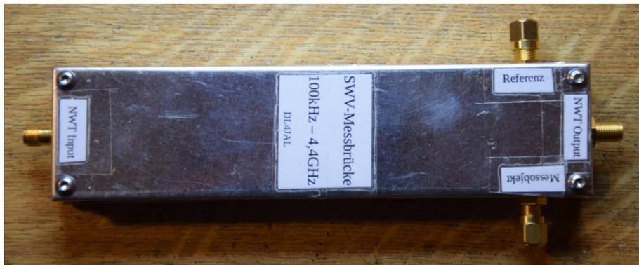
Hier noch die Messbrücke mit den aufgeschraubten Deckel. Der Referenzwiderstand 50 Ohm ist aufgeschraubt und ein zweiter Referenzwiderstand 50 Ohm, zum Messen der Richtschärfe.
