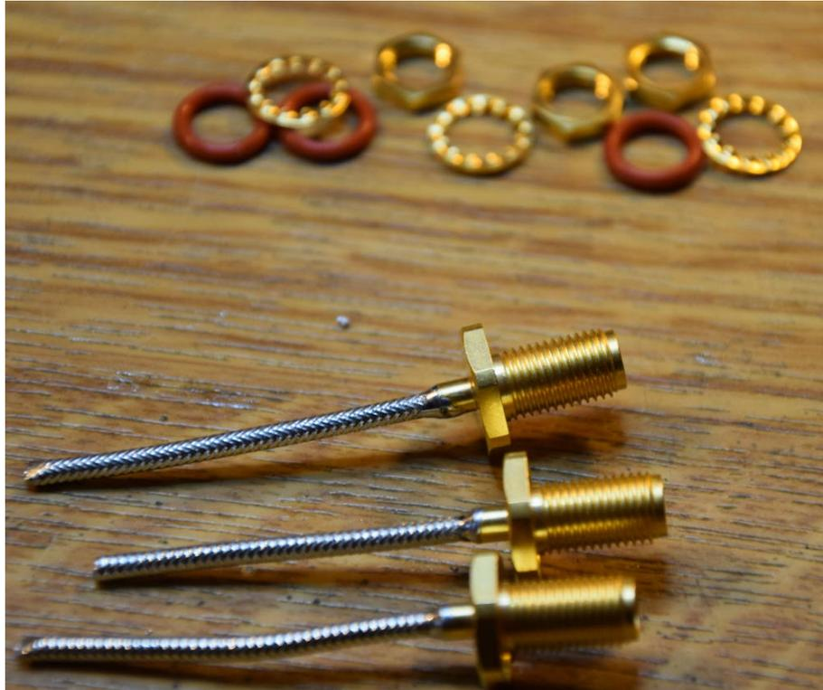
Zuerst löten wir die 3 kurzen (etwa 45mm) und das eine lange (etwa 130mm) RG405 Semi-Rigid Kabel (bei Ebay bestellt) in die Buchsen (Reichelt, Artikel-Nr.: R 125 326) ein. Das eine lange RG405-Kabel mit Buchse, war bei mir schon fertig und ist hier nicht zu sehen. Ich habe es von einem Flohmarkt.
