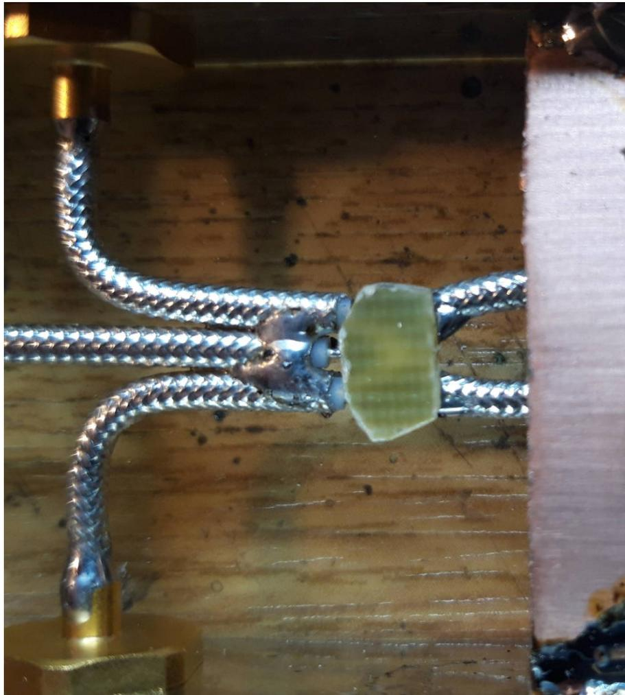
Werden Mikrowellenwiderständen SMD 0402 verwendet, wird die kleine Leiterplatte ebenfalls direkt an die 3 Seelen der Koaxkabel angelötet. Hier nur von unten zu sehen.
