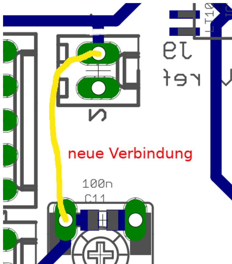
J9 wird direkt mit der Betriebsspannung verbunden. Stecker J9 brauchen wir für den Drehgeber als Versorgungsspannung für die Entprellung.
