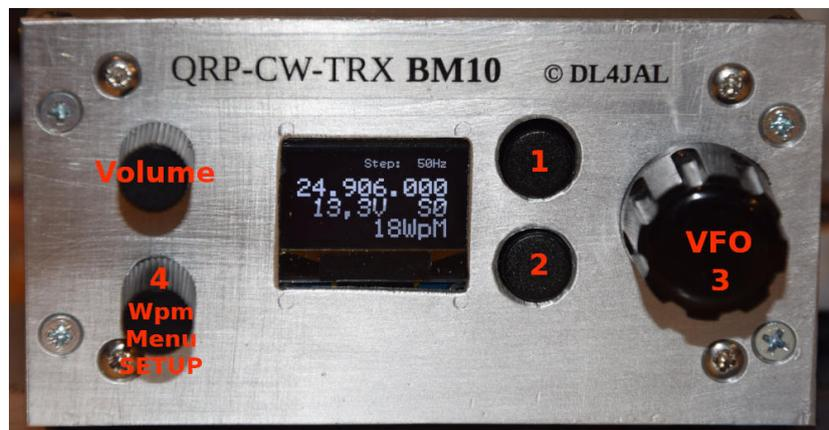
Oben links das Poti für die Lautstärke. Darunter der Drehgeber mit Rastung und Tastenfunktion *Taste 4*. Rechts der Drehgeber ohne Rastung ist für den VFO. Zusätzlich im Dregeber-VFO die Tastenfunktion *Taste 3*. Rechts neben dem Display die Einzeltasten *Taste 1* und *Taste 2*.
