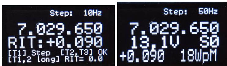
(Links) befinden wir uns in der RIT-Funktion und können die Empfangsfrequenz verstellen. Nachdem eine RIT-Frequenz eingestellt wurde und die Funktion verlassen wird, sieht es so aus (Bild rechts). Ist RIT aktiv sieht man die Frequenzablage in der untersten Zeile links.
