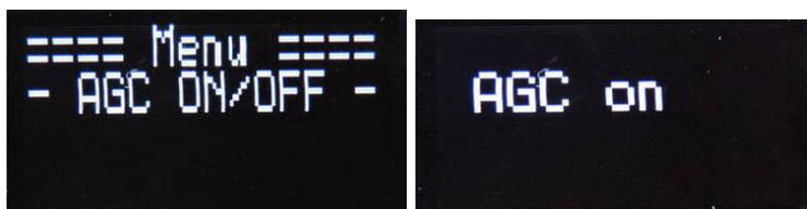
Anschließend wird kurz der „AGC-Zustand“ angezeigt. Auch nach PowerON wird auch der AGC-Zustand gezeigt, da der Zustand dauerhaft im Eeprom abgelegt wurde. Die Anzeige soll erinnern ob die AGC aktiv ist. Wurde die AGC abgeschaltet erinnert im Display letzte Zeile „AGC off“ kleine Schrift daran.
