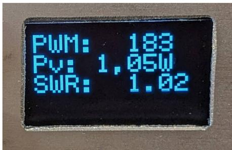
In Zeile 1 sehen wir die Nachreglung der PWM. Zeile 2 zeigt die reduzierte Sendeleistung an 1,05 Watt und in Zeile 3 das momentane SWR 1,02.
