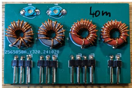
Als Beispiel das Bandmodul für das 40m-Band, 7,30 MHz. Rechts die 2 Ringkerne sind für den Tiefpass der PA. Links die 2 Ringkerne + die 2 SMD-Trimmer sind für die Vor-Selektion des Empfängers.
