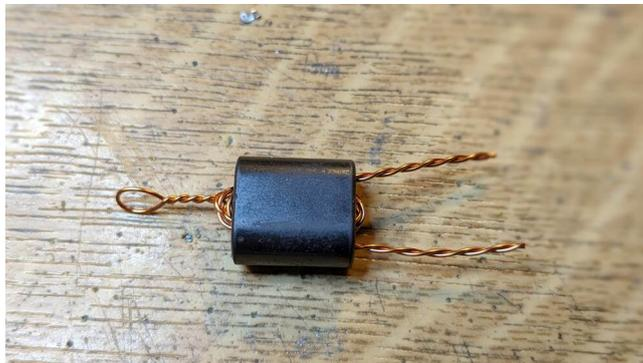
Das Verdrillte wird das dritte mal durch den Doppellochkern gesteckt. Das sind jetzt pro Draht 2x 1.5 Windungen.
