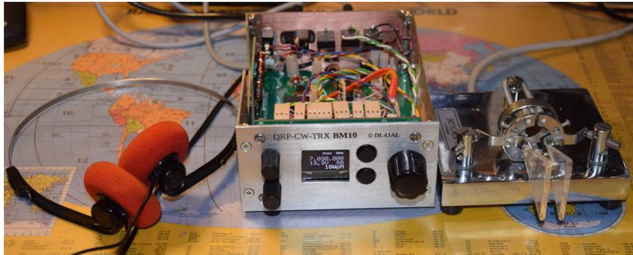
Ich habe einen CW-QRP-TRX BM10 entwickelt für alle Kurzwellenbänder. Die Frequenzumschaltung erfolgt mit Bandmodulen die umgesteckt werden. Dazu inspiriert hat mich der QRP-Transceiver „Sierra“. Der ebenfalls mit Bandmodulen arbeitet. Ich habe alt bewährte ICs NE602 eingesetzt. Die dürfte fast jeder Bastler noch in seiner Bastelkiste haben.
