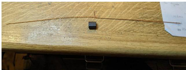
Beide Wicklungen primär und sekundär werden eng miteinander verdrillt. Die kleine Schlaufe ist die Mittelanzapfung.
