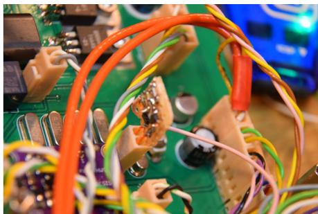
Im Bild die kleine AGC-Baugruppe mit SMD-Bauteile auf Lochraster gelötet. Der rosa Draht führt zur MC-Platine J7, Pin1.
