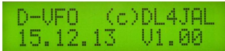
Basierend auf meinen Allband-VFO [1] habe ich mit anderer Software im PIC18F4520 der Steuerplatine und den Einsatz von zwei DDS Platinen mit dem AD9951 einen Doppel-VFO entworfen. Dieser VFO eignet sich hervorragend vor die verschiedensten IM3 Messungen, da das erzeugte 2-Tonsignal bei einem maximalen Pegel von -2dBm noch einen IM3 Abstand von etwas  $>$  als 80dBc hat. Siehe Abbildung ?? auf Seite ??.
