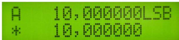
Mit dieser Funktion wird der DDS1 auf Frequenz 0Hz programmiert. Dadurch wird der DDS quasi abgeschaltet. Als Kennzeichen, dass ein DDS abgeschaltet wurde wird auf dem Display in Zeile2 ganz links ein „\*“ eingeblendet.
