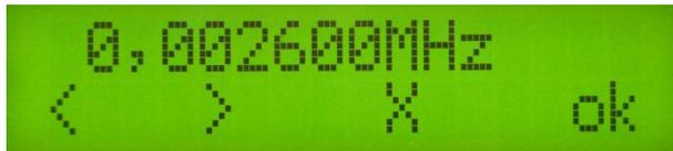
Frequenz Offset2 2600Hz. In diesem Menüpunkt wird die Offsetfrequenz2 eingestellt. Diese Frequenz wird je nach Modes LSB oder USB subtrahiert oder addiert.
