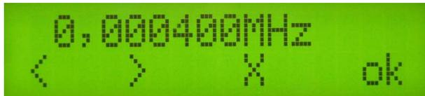
Frequenz Offset1 400Hz. In diesem Menüpunkt wird die Offsetfrequenz1 eingestellt. Diese Frequenz wird je nach Modes LSB oder USB subtrahiert oder addiert.
