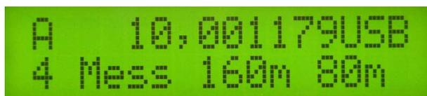
Sicht auf die weiteren Menüebenen. Die weiteren Menüpunkte sind Frequenzspeicherplätze. Diese habe ich so gelassen wie beim AllbandVFO. Sie funktionieren wie beim Bandwechsel. Die Frequenzeinstellung des vorherigen Bandes wird gespeichert.
