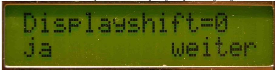
Mit der Taste „ok“ oder „ja“ wird der Shiftwert auf 0 gesetzt und wir sehen die eigentliche Empfangsfrequenz. Deshalb muss zuerst im normalen Betrieb die genaue Empfangsfrequenz eingestellt werden (ZF-Ausgang des Transverters) und anschließend den anzuzeigenden Frequenzwert der Transverterempfangsfrequenz.
