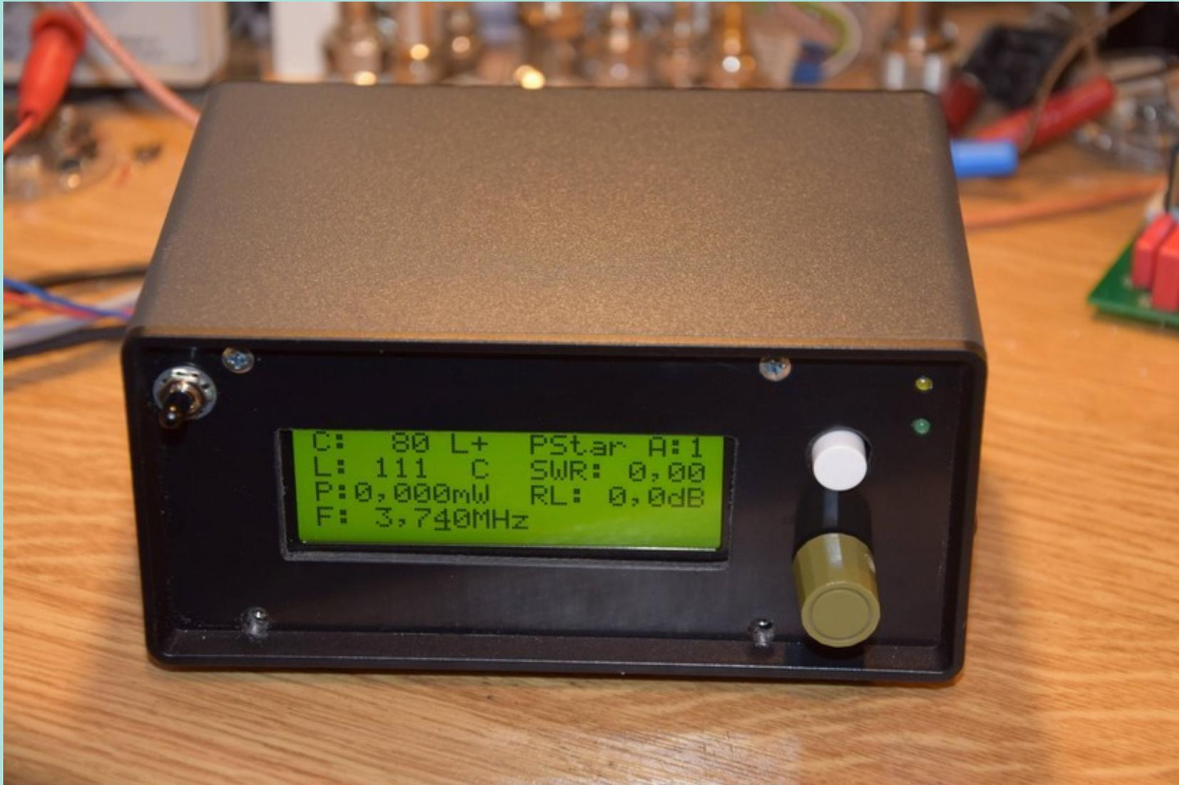
Der PicATU500 wird über die Fernsteuerung gesteuert. Die LCD-Anzeige hat 4 Zeilen für die Anzeige aller Informationen.
