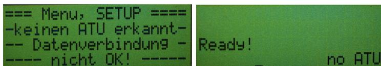
Das linke Bild kommt wenn man mit der Einzeltaste versucht das *Menü* aufzurufen. Rechtes Bild ist das Display wenn noch keine Verbindung zum ATU aufgebaut ist. (**Anzeige ab FW 1.11**)
