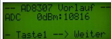
Die Verbindung zum Übertrager trennen wir ab und mit einem genauen Kalibrierpegel von 0,0dBm ermitteln wir den ersten Wert des A/D Wandlers im PIC. Die Zahl ist sehr groß die Wandlerbreite im PIC ist nur 10Bit (max 1023). Ich addiere aber bei jedem Messdurchgang 32 Einzelmessungen. Daher die große Zahl „10816“.
