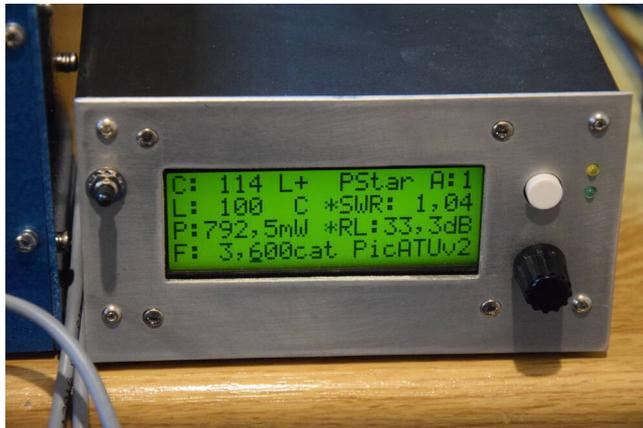
Die Fernbedienung mit der Software Version 2.0. Unten rechts wurde die neue Tuner-HW erkannt. Das Display zeigt die Sendeleistung und die Anpassung an die Kunstantenne.
